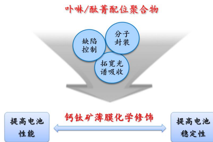
图 1 卟啉/酞菁配位聚合物对钙钛矿薄膜修饰策略示意图
